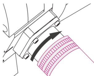
ロボット動作時にコネクタが外れないように
