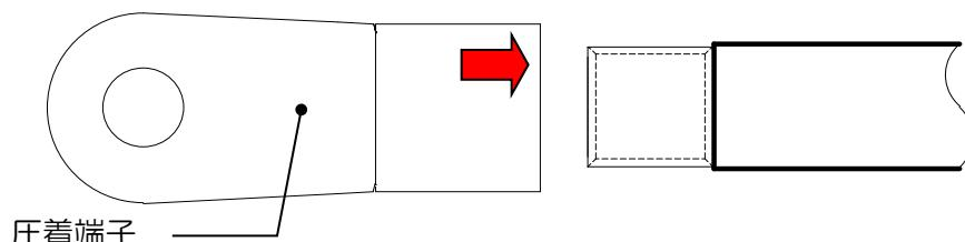
図 14. 圧着端子加締め
