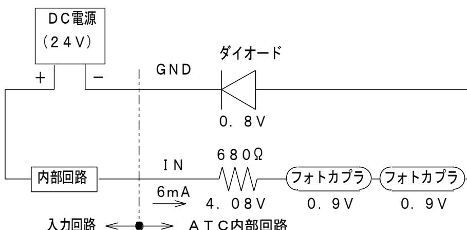
よって、OVコモンに対して 8(V) 以上の電圧でON判定可能な入力機器を選定して下さい。
