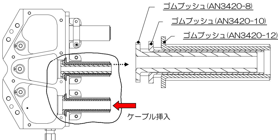
図 12. 給電ケーブル組付け
