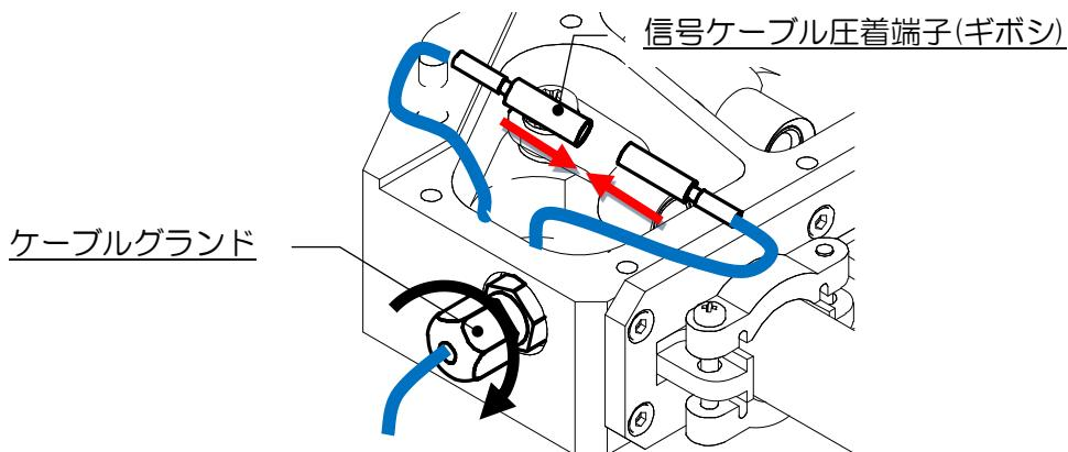
図 19. 信号ケーブル圧着端子接続、収納
