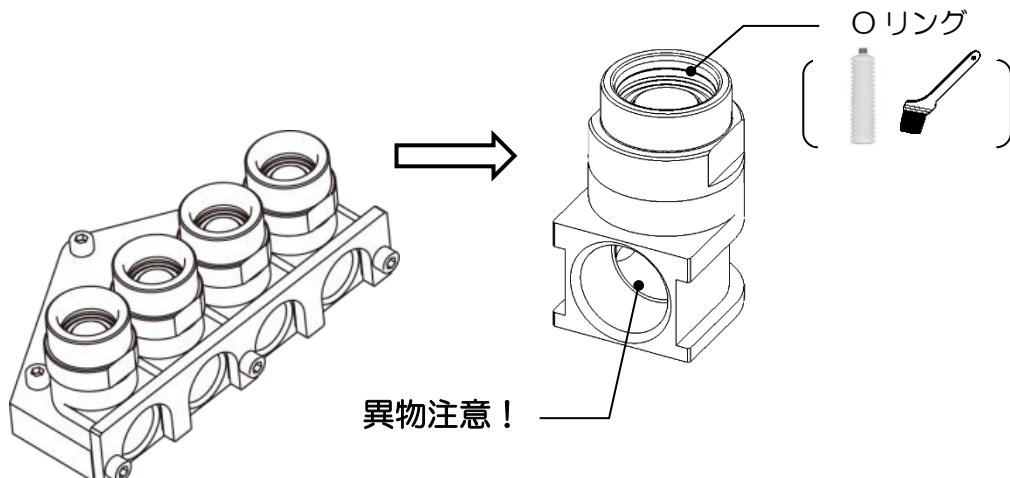
図 21. 給水ポート ASSY 給脂箇所
