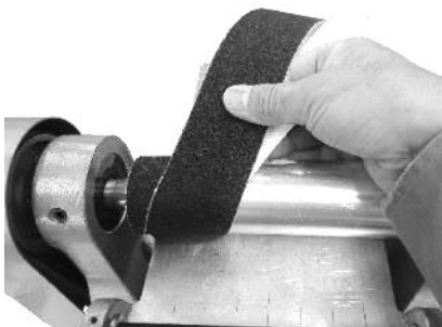
端部から隙間なく貼付け
