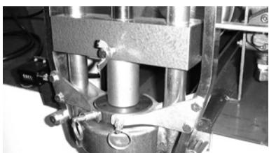
1 油圧シリンダを降下させ、左右のダイ間隔が1~1.5mm程度の位置で止めます。
