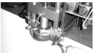
1 操作レバーを手前に引き、ブッシャーがダイの上面につくまでシリンダを降下させます。
