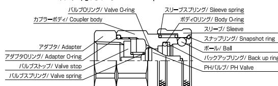
残圧下での接続が可能なPHバルブ機構※を採用しています。
