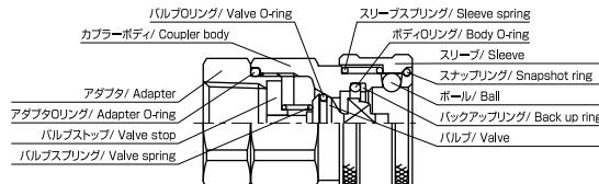
開閉式バルブ機構を備えたタイプです。 It is a type having open-shut valve mechanism.
