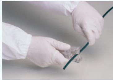
⚠ **注意** チューブ切断部分に汚れ、へこみ、傷、つぶれ、バリ、毛羽立ちなどがないようにカットしてください。また、チューブを斜めに切断しないでください。チューブ挿入時に継手のシール部分を傷つけ、漏れの原因となります。
