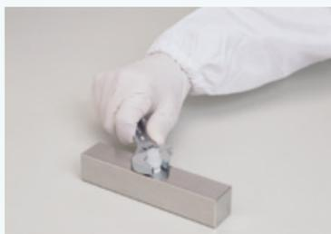
⚠ **注意** ねじ部が樹脂製のため、締め付けすぎるとねじ部が破損したり変形し、漏れなどの原因となります。
