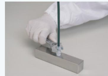
⚠ **注意** ナットの六角 (HEX) 部分は樹脂製のため、取り付けにはモンキレンチを使用してください。スパナは、六角部分を損傷させる可能性がありますので使用しないでください。
