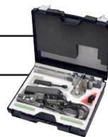
**フィンガーパンチャー** フィンガー継手を製作する工具です。
