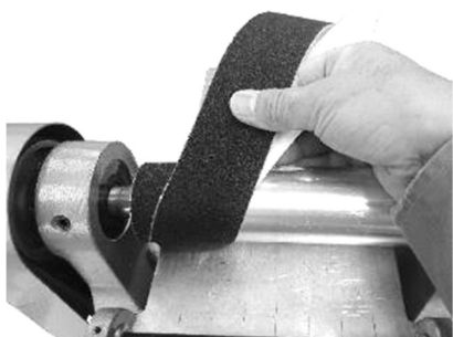
端部から隙間なく貼付け
