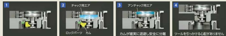
カムがエア圧によるピストンの上下運動に連動して開閉することで、連結・分離を行います。ピストンがカムの開閉を確実にコントロールします。
